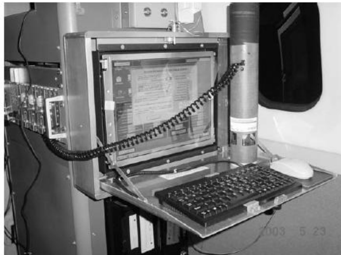
圖二、機上電腦系統及投落送探空儀及其訊號接收系統設備圖。
